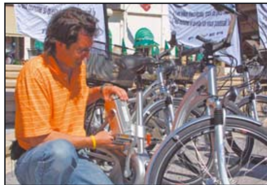
Alex Barras installe la batterie au bas du cadre du vélo électrique. PDM
